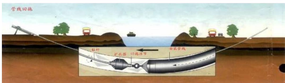
图 3.2-6 管线回拖示意图
