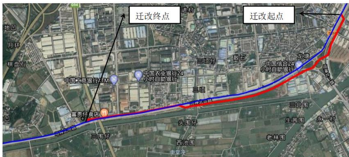
图 3.1-1 现有管道及迁改管道位置示意图（蓝色为现有管道，红色为迁改方案）
