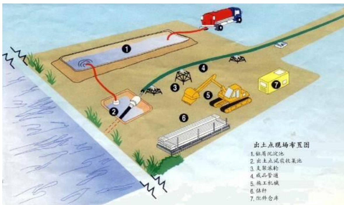
图 3.2-8 定向钻穿越施工出土点现场布置图
