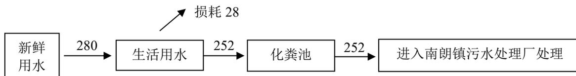
图 3.8-1 项目运行期水平衡图 (t/a)
