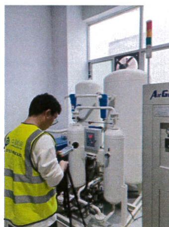
空压机旁噪声检测
