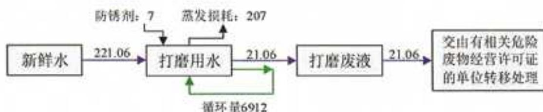
图 3.5-1 技改项目一期水平衡图（单位：吨/年）
