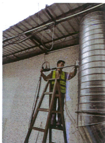
注塑成型工序废气处理前采样口
