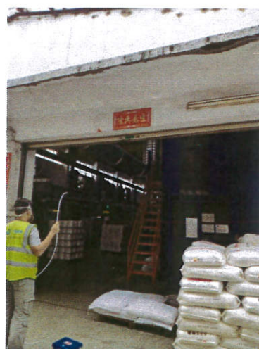
注塑成型车间门口无组织废气采样
