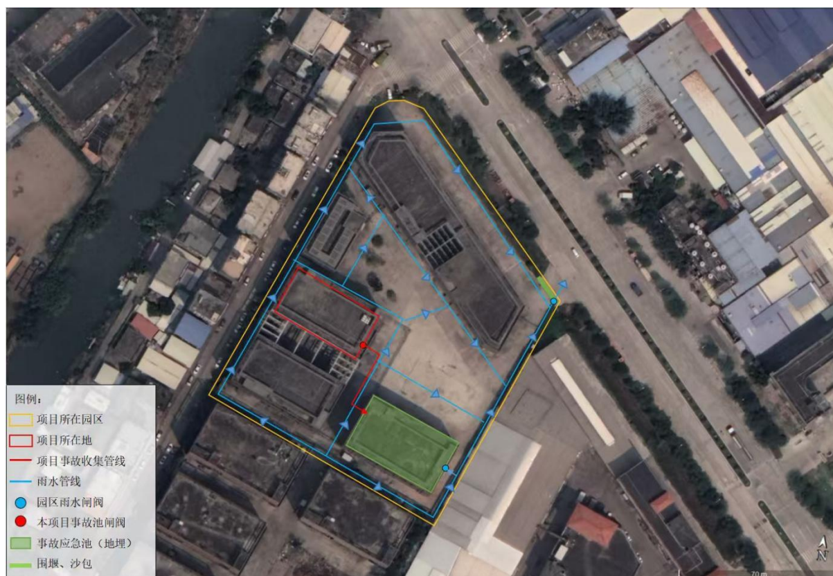
图 6.6-2 项目区内雨水管网及雨水阀门示意图
