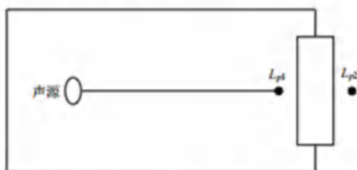
图7.5-1 室内声源等效为室外声源图例
